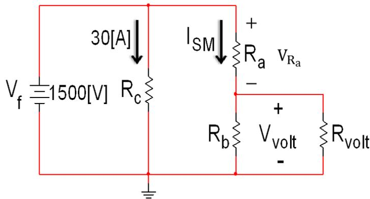
**Figura 6. Circuito Literal a) Asignando Polaridad a  $V_{R_a}$**
