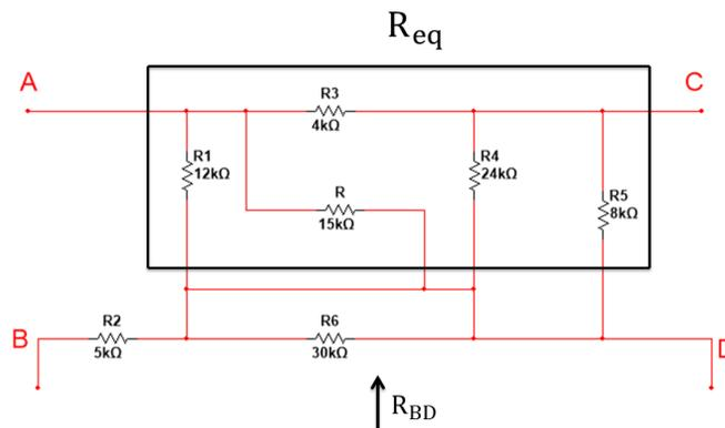
Figura 19. Circuito Literal c) Indicando Req
