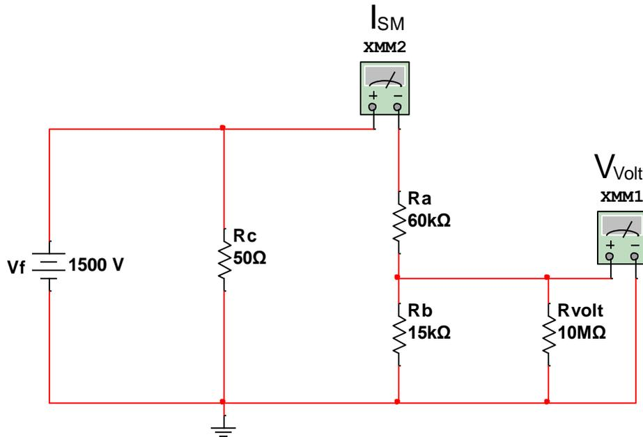
Figura 9. Lectura de  $V_{volt}$  e  $I_{SM}$  en Multisim 12
