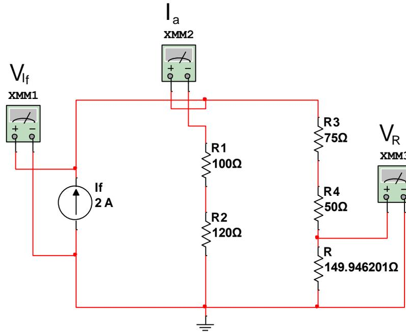
Figura 4. Lectura de  $V_{I_f}$ ,  $I_a$  y  $V_R$  en Multisim 12
