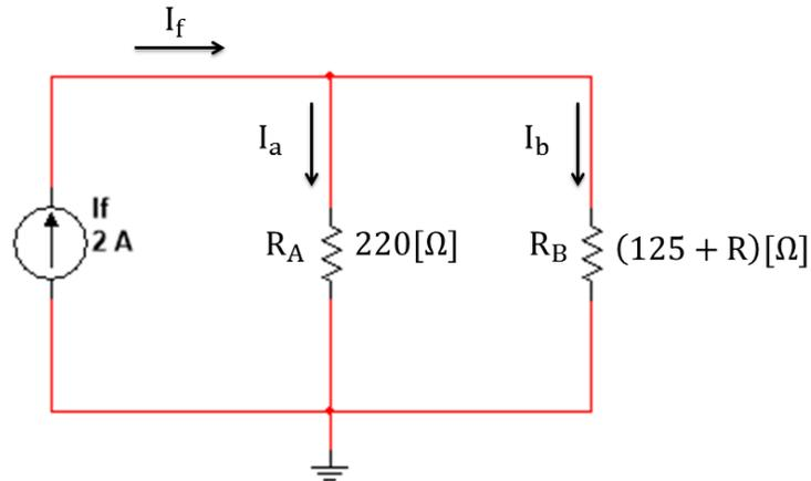
**Figura 2. Circuito Transformado Mediante Reducción de Resistencias**
